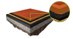
Ursprüngliche Bauweise von **REGUPOL** Hybrid-Sandwich-Belägen. Die **REGUPOL** Basismatte erhält einen Porenschluss.
